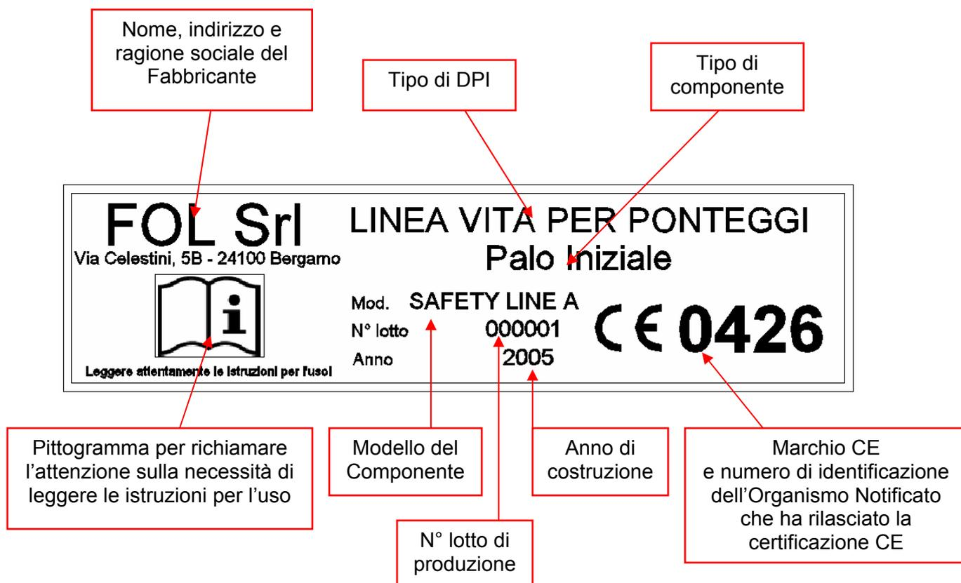
La marcatura dell'ancoraggio mobile per le ridotte dimensioni del componente non può essere apposta sul componente stesso e perciò viene di seguito riportata:
