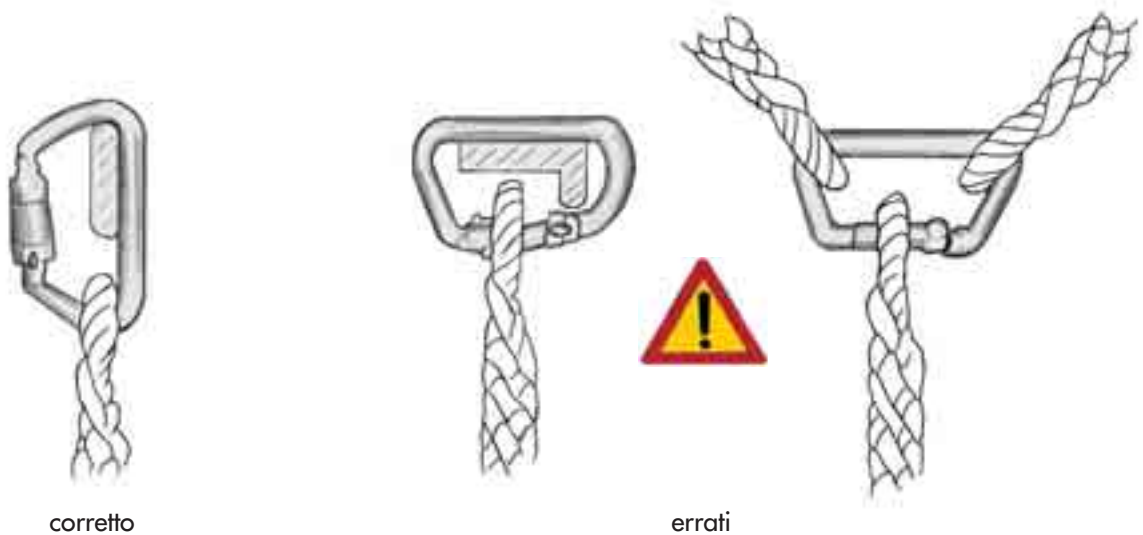
Fig. 16 - Carichi non in asse con la spina
